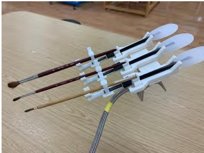
国リハと連携し、3Dプリンターで筆用のスタンド制作
